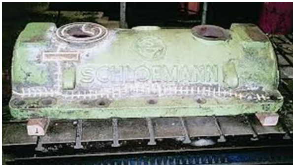
Figuur19. Repareren van gietijzer met behulp van krammen.
